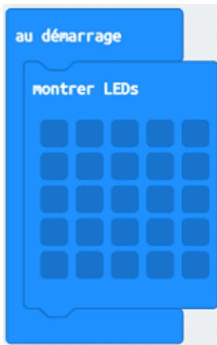
Il suffit de cliquer sur les cases représentant les LEDs pour dessiner l'icône souhaitée.
