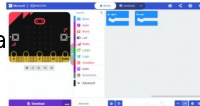
**MakeCode** est une plateforme de programmation visuelle développée par Microsoft qui utilise des blocs de code graphiques pour permettre aux débutants de créer des programmes simplement en les glissant-déposant sur une zone de travail.
